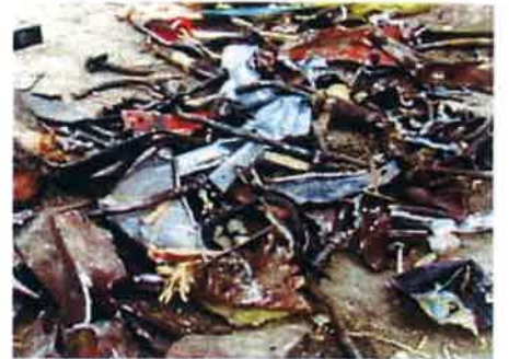
廃材より分離された金属を強力に除去。下の写真は磁選機により除去された金属類。
