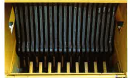
2枚のくしの歯を交差させるような粉碎メカニズム
